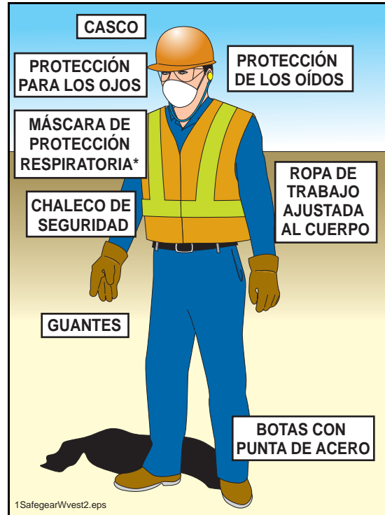
Figura 89 Use equipo de protección personal (PPE)
