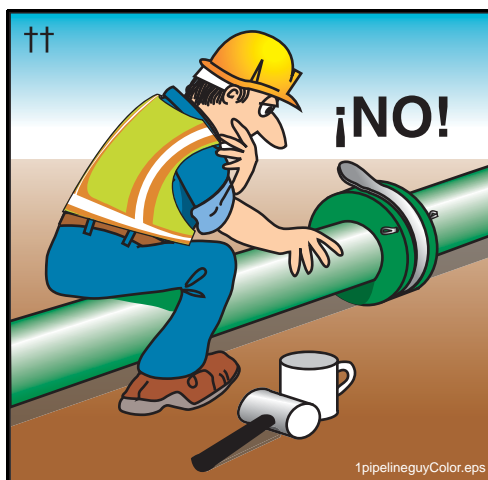
Figura 81 Nunca se ponga a horcajadas o se siente sobre una tubería presurizada
